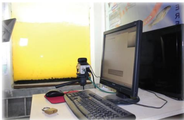
Le dispositif de comptage : à gauche la caméra qui scrute le passage des poissons et à droite une vue du dernier bassin de l'échelle à migrateurs avec les vitres de chaque côté du passage
